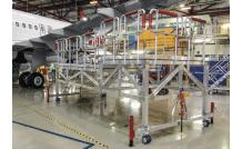
Außen liegende Docks für den Zugang zu den Vorder- und Rückseiten sowie Ober- und Unterseiten der Flügel, Triebwerken, Querrudern, Lande- und Störklappen und Flügelkanten.
