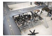
Lösung mit mehreren Ebenen für Wartung und Reparatur speziell an den Triebwerken und Propellern.
