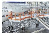
Strebenfreie Konstruktion mit Zugang zu den vertikalen Stabilisatoren und ergonomische Neigung der Arbeitsfläche. Für Tail-In Dockvorgänge muss das Dock nicht bewegt werden.
