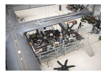
Solución multinivel para mantenimiento y reparación, especialmente en motores y hélices.
