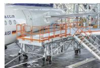
Construcción sin travesaños con acceso a los estabilizadores verticales e inclinación ergonómica de la superficie de trabajo. No hay necesidad de mover la dársena para el atraque de cola.
